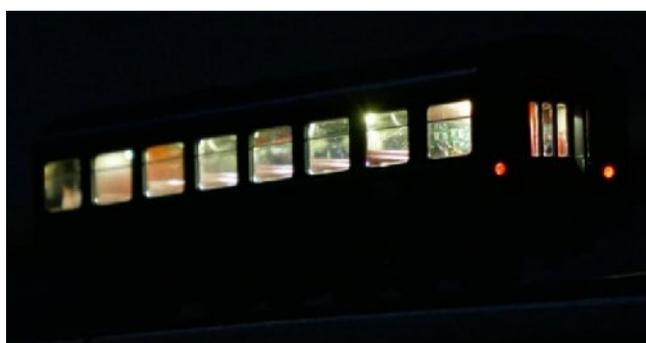
**Bild 18 und 19:** Beleuchtungseindruck mit fahrtrichtungsabhängigem Schlusslicht, insgesamt 8,5 mA.
